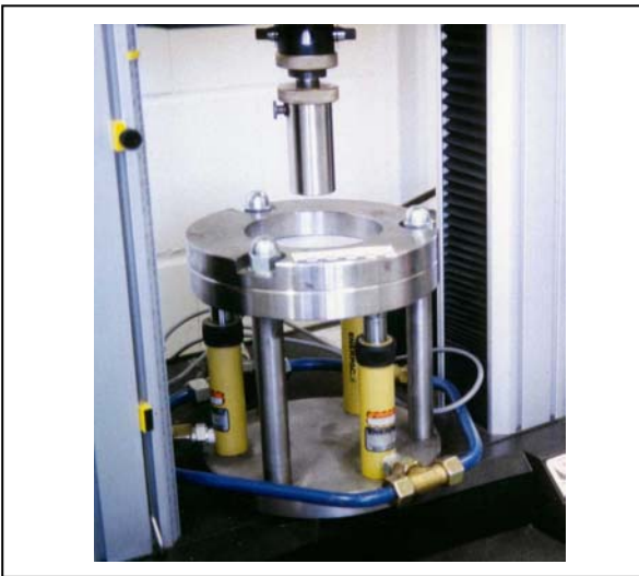
Prüfeinrichtung für Stempeldurchdrückversuch - CBR - test mit hydraulischer Klemmung im tBU
