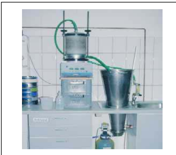
Prüfeinrichtung zur Bestimmung der wirksamen Öffnungsweite ( O_{90,W} ) im tBU
