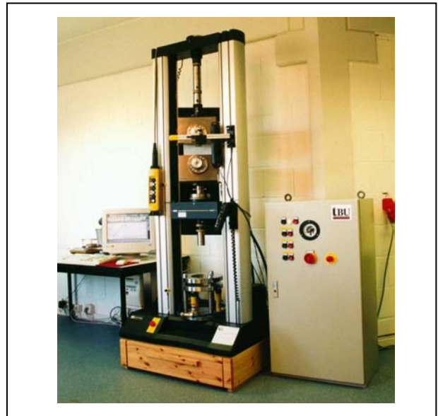
Prüfmaschine ± 30kN für Höchstzugkraft / Höchstzugkraftdehnung mit hydraulischen Spannköpfen im tBU
