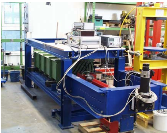
Bild 1: Pullout-Box mit eingebautem Boden und Probe
