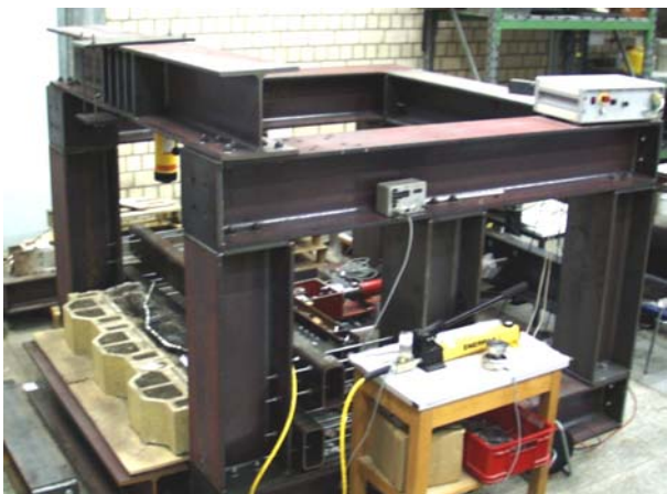
Bild 1: Versuchsanordnung des Pullout-Rahmens
