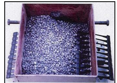
Bild 6: Geokunststoff in Korund eingebettet vor Belastung
